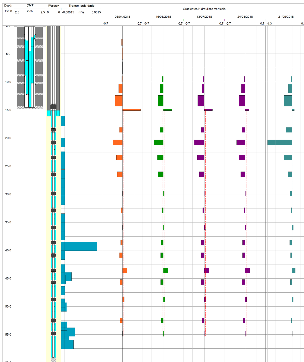
Figura 29: Transmissividade das fraturas do aquífero fraturado, ao lado do perfil dos poços CMT e Westbay e de perfis de gradientes hidráulicos de diferentes datas em diferentes meses.
